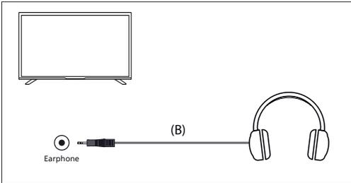
Wenn kabelgebundene Kopfhörer an die 3,5-mm-Klinkenbuchse des Fernsehers angeschlossen werden, schalten sich die internen Lautsprecher aus. Die Lautstärke des Tons, der über die Kopfhörer kommt, wird über die Fernbedienung mit den **[VOL+]** und **[VOL-]** Tasten gesteuert.
